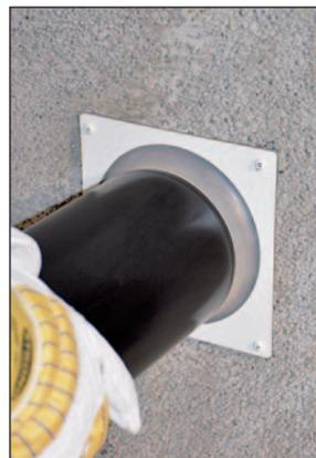
Bauseitige Zuluftleitung in BlowerDoor Zuluftblende einschieben.
