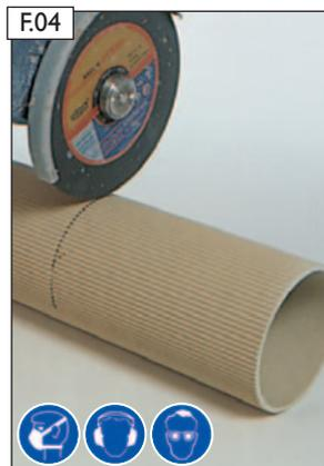
Glattes Rohrende verwenden, anzeichnen und mit Winkelschleifer zuschneiden.
